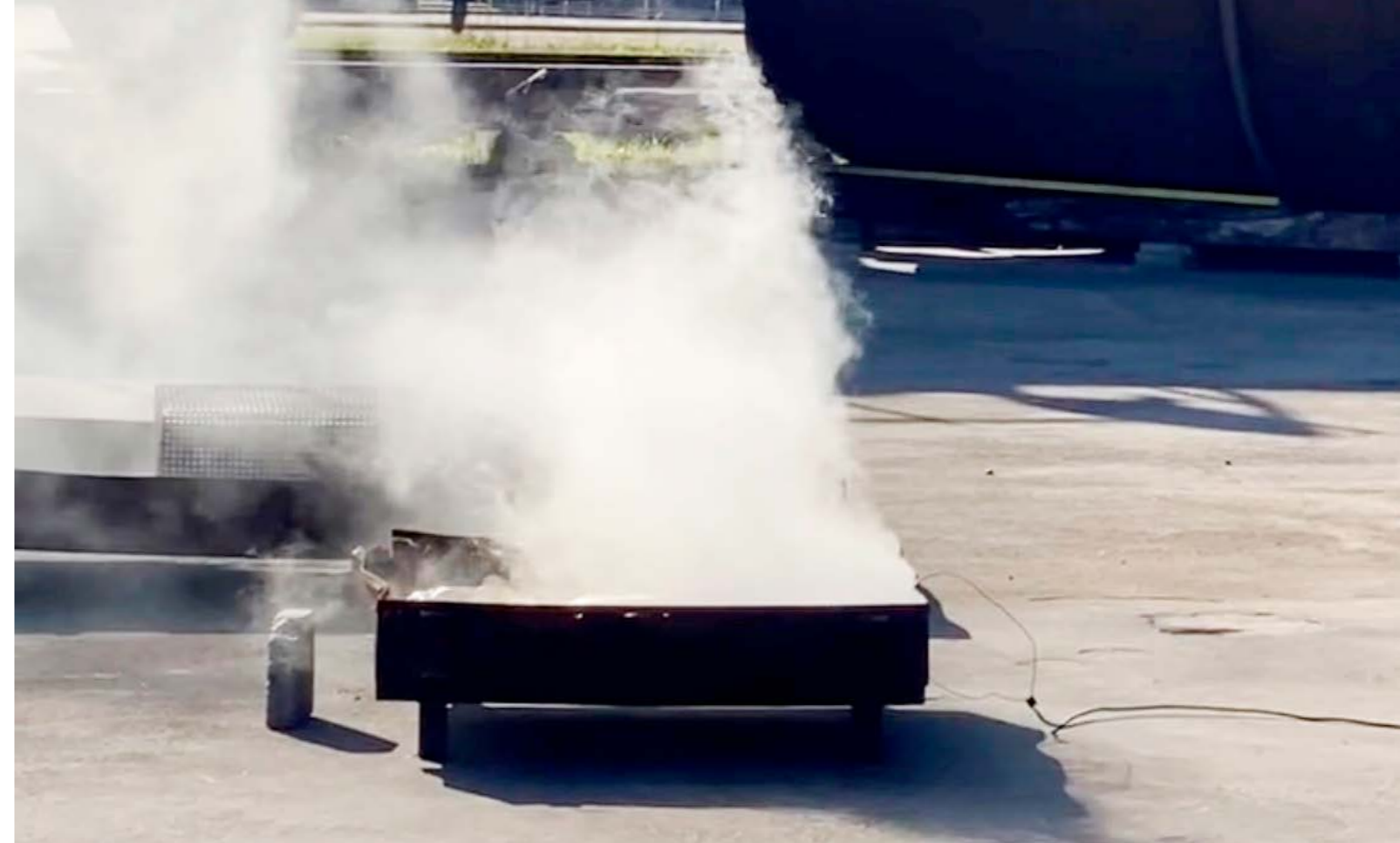
Photo 2: Phase 1 – Le «thermal runaway» (réaction en chaîne dans la batterie) dû au court-circuit de cellules individuelles.
