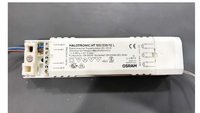
Photo 3: Ballast électronique (non soupçonné de contenir des PCB).
