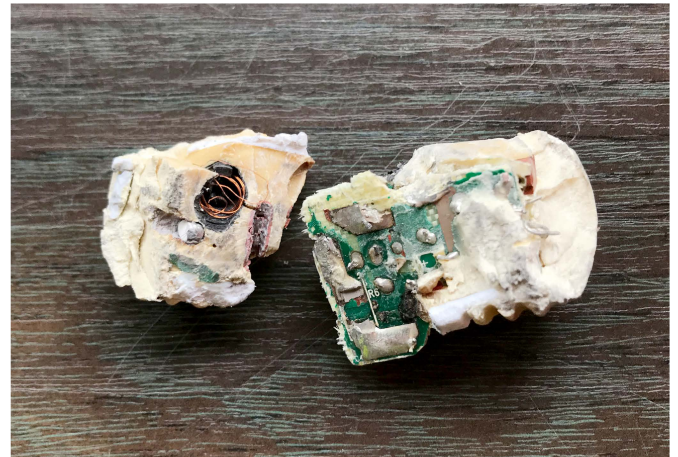
Photo 2: Dans certaines LED, les précieuses cartes électroniques sont coulées dans un autre matériau
