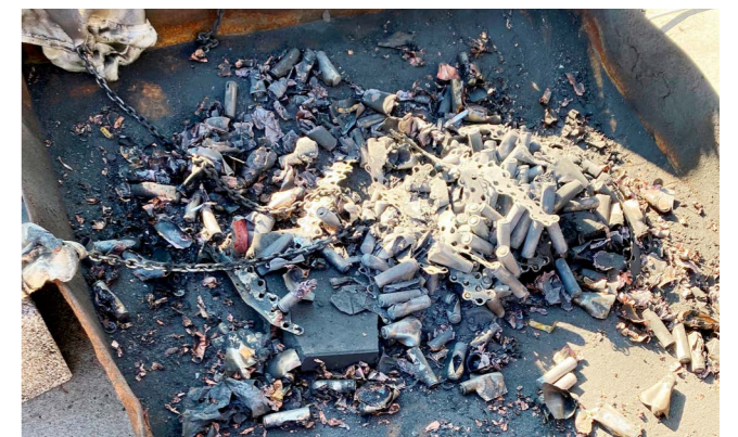
Photo 4: Phase 3 – Les résidus après l'essai d'incendie.
