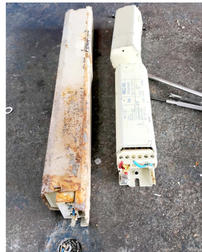
Photo 2: Deux ballasts suspects qui ont été trouvés au milieu d'autres ballasts non suspects dans un conteneur, dans le cadre de l'assurance qualité. Le schéma électrique sur le ballast de droite signale le condensateur par un symbole et l'abréviation «kap» (partie capacitive).
