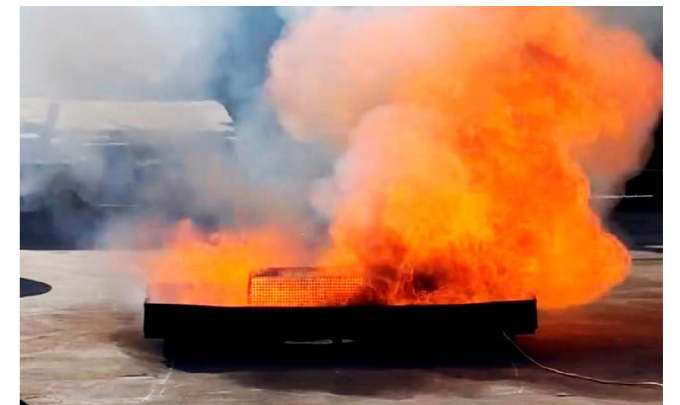
Photo 3: Phase 2 – La batterie est en feu et dégage une vague de chaleur intense.
