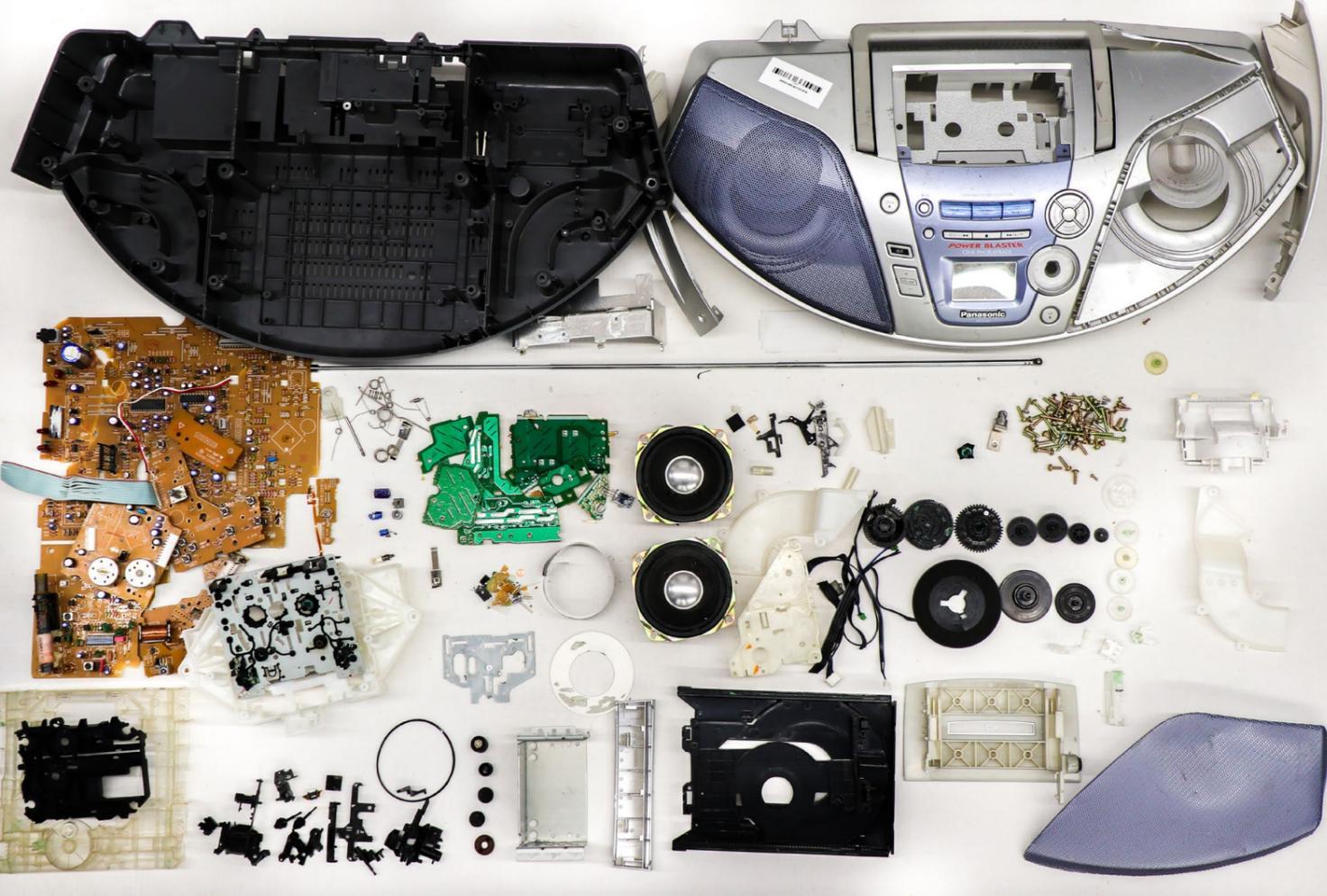
Figure 3: ghettablaster après un démontage fin.
