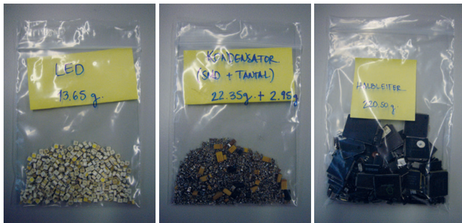
Fig. 4: Composantes démantelées et échantillons traités de dispositifs électroniques automobiles
