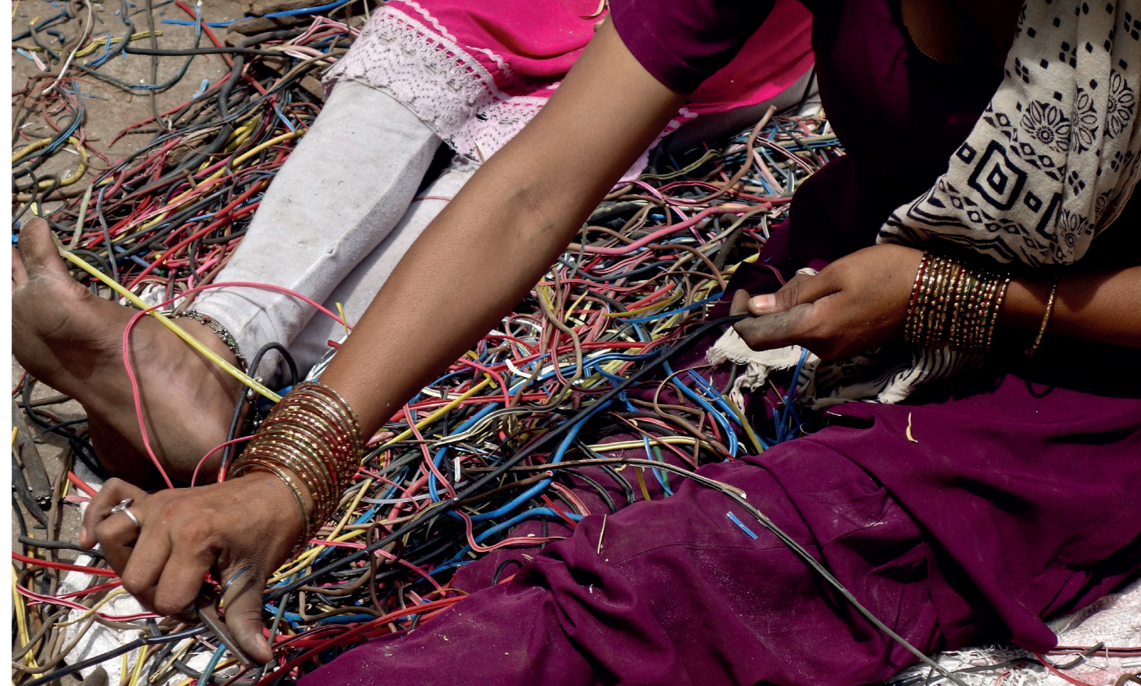
Foto 1: Schälen von Kabeln und Farbsortieren von Fraktionen im informellen Sektor in Delhi, Indien.
