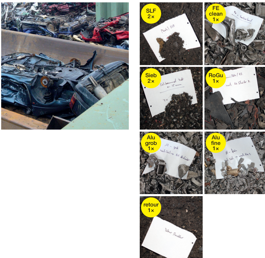
Abbildung 5: Schredder-Input und Proben aus den Output-Fraktionen
