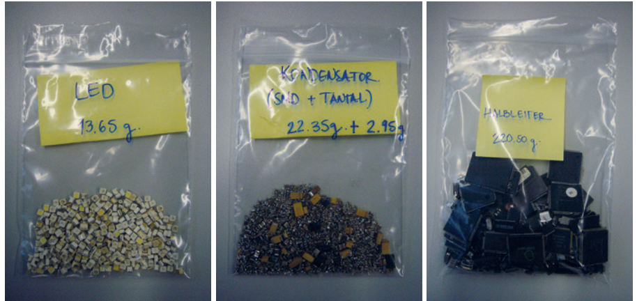
Abbildung 4: Zerlegte Komponenten und aufbereitete Proben aus Automobil-Elektronikgeräten
