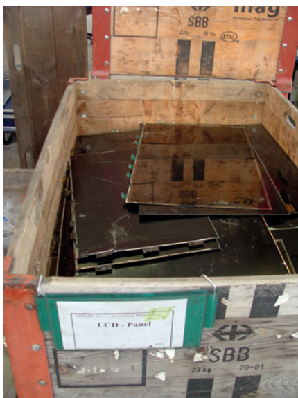
Abbildung 3: LCD-Panel mit Indium-Zinnoxid
