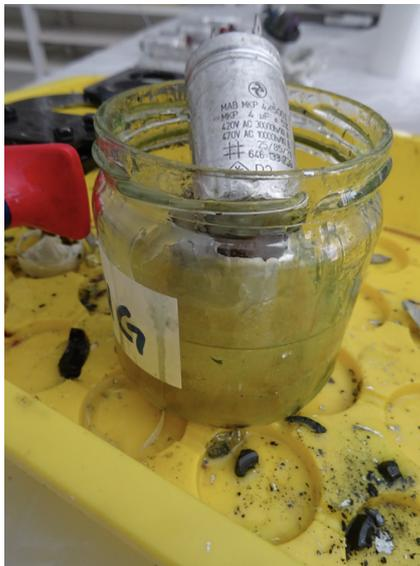
Probenahme für die Laboranalyse der Flüssigkeiten
