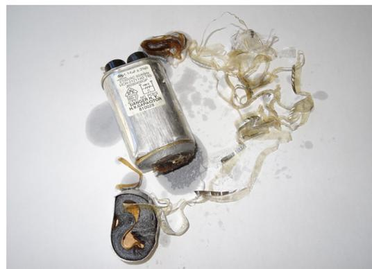
Innenleben eines Mikrowellenkondensators
