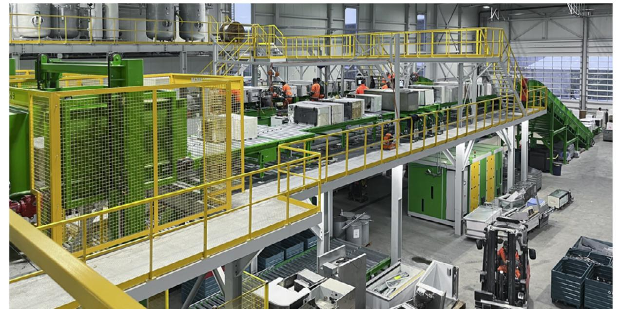
Installation de recyclage pour appareils frigorifiques Erdwich d'Immark AG Au centre: étage supérieur de l'installation avec stations d'aspiration. À gauche: sortie des appareils pour le niveau 2 de traitement, avec installation de production de N<sub>2</sub> à l'arrière-plan.
