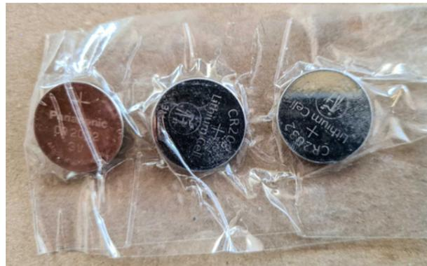
En présence de grandes quantités, recouvrir de ruban adhésif les piles boutons au lithium évite les courts-circuits (photo: soRec)
