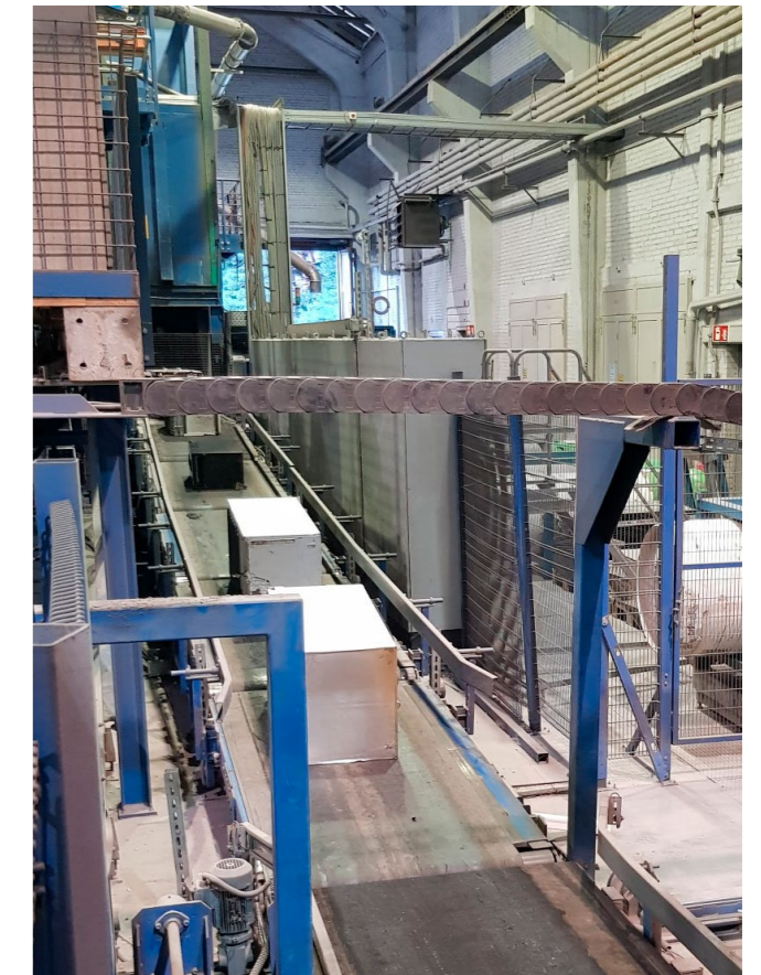
Foto 3: Geräteaufgabeband für die 2. Verarbeitungsstufe.
