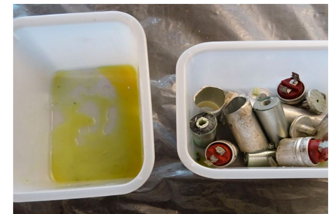
Foto 1: Separation von Feststoffen und Flüssigkeiten nach vier Monaten Abtropfzeit.
