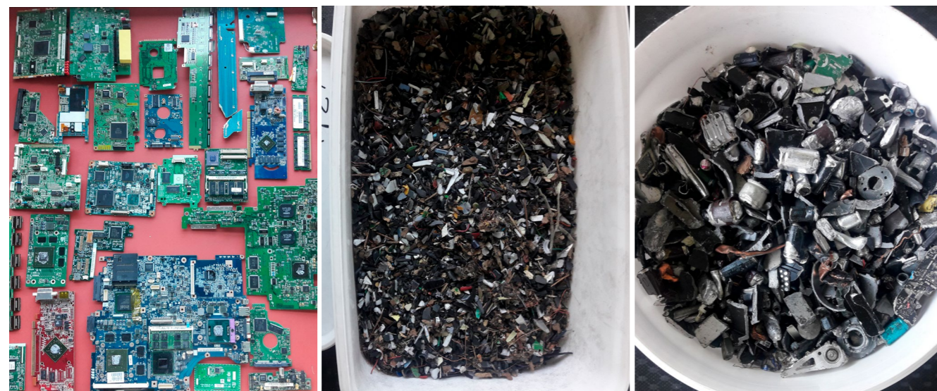
Abbildung 4: Beispiele erzeugter Fraktionen (v. l. n. r.): Aus der Feinzerlegung gewonnene Leiterplatten der Klasse 1 aus moderneren elektronischen Geräten; im Batchversuch ausgesiebte Kunststofffraktion mit hohem Edelmetallgehalt (bedeutender Leiterplattenbruchanteil); im Batchversuch mit Wirbelstromabscheider gewonnene Aluminiumfraktion. Es sind etliche Elektrolytkondensatoren zu erkennen, welche beim Aufschluss zwar etwas verletzt, aber in dieser Fraktion fast vollständig abgeschieden wurden.
