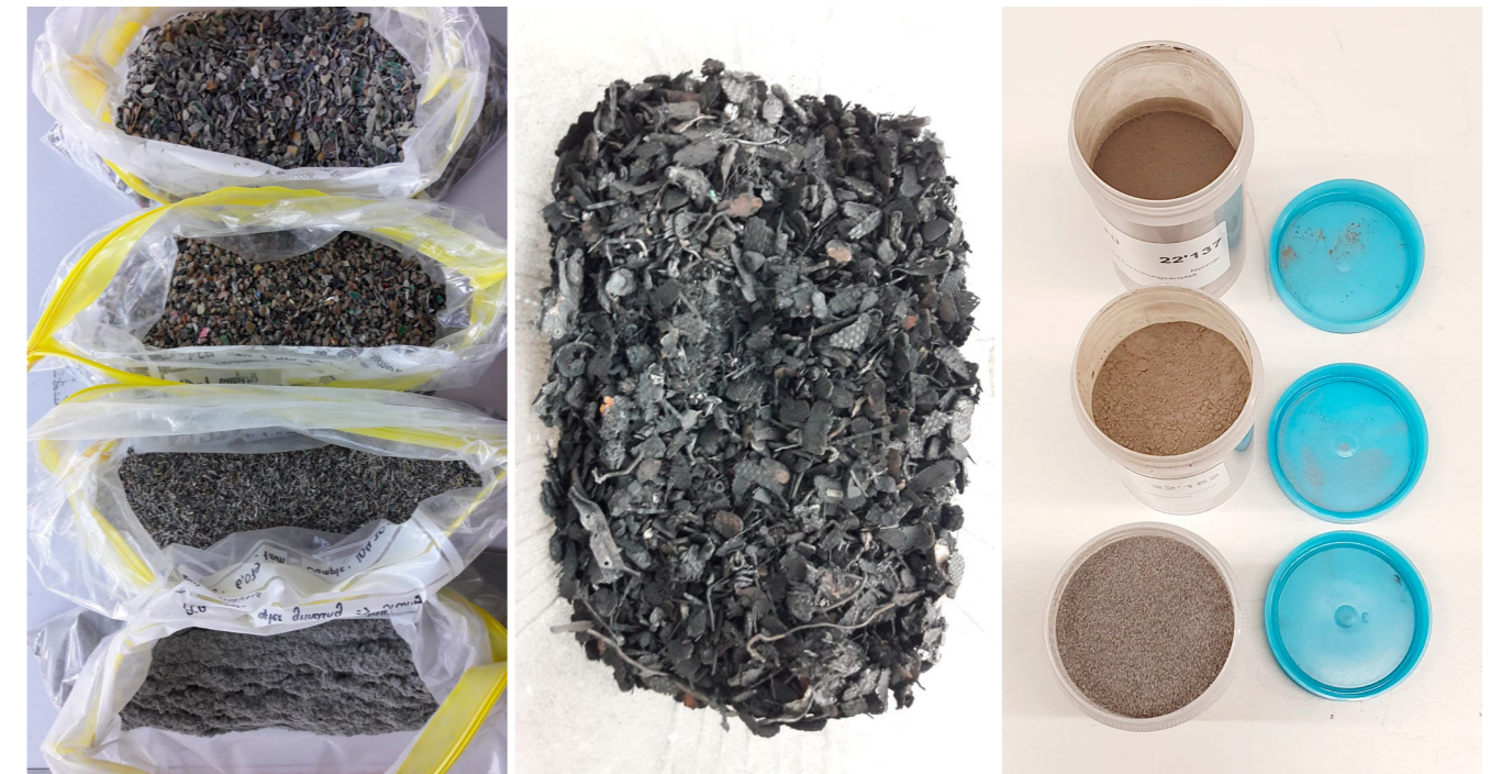
Abbildung 5: Beispiele aufbereiteter Proben (v. l. n. r.): Siebfraktionen unterschiedlicher Korngrößen von gemahlene Leiterplatten (LP), welche der Untersuchung der Verteilung verschiedener Stoffe (insbesondere von Edelmetallen) in den verschiedenen Matrizen dienen; pyrolysierte LP-Fraktion, aus der alle flüchtigen Bestandteile entfernt und in Lösungen abgeschieden und untersucht wurden; in Kryomühle erzeugte Mahlfaktionen (v. u. n. o: Kunststofffraktion, Nasswäscherschlamm, RESH).
