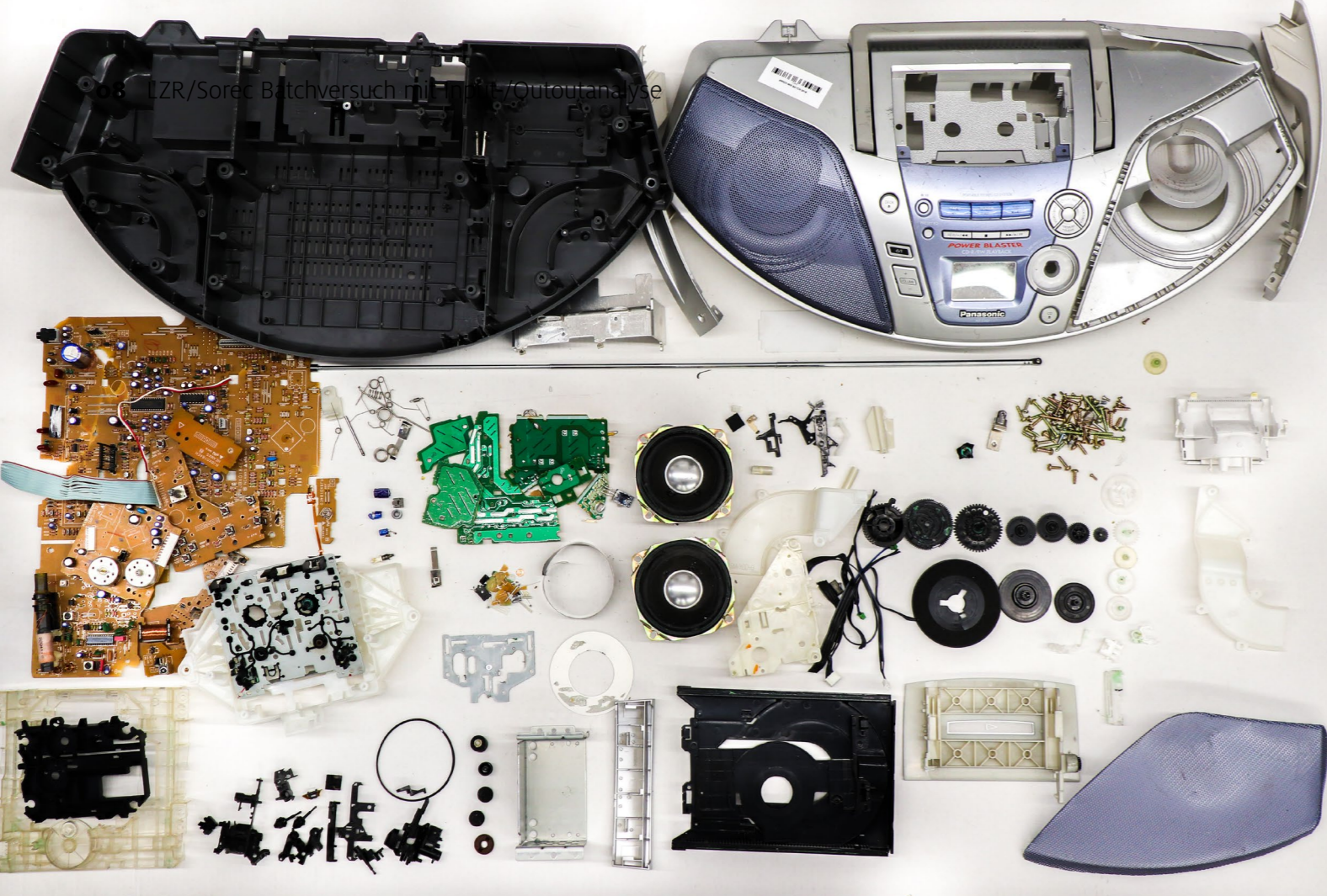
Abbildung 3: Fein zerlegter Gehhtoblaster.
