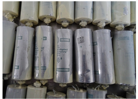
Un modèle de condensateurs provenant des ballasts électroniques
