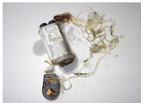
Fonctionnement interne d'un condensateur à micro-ondes
