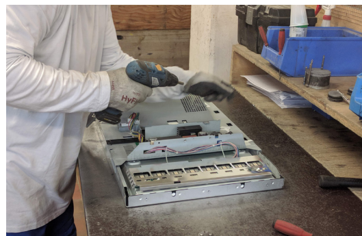
Démontage manuel d'un moniteur informatique
