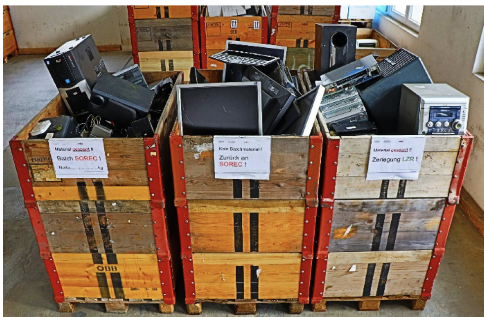
Figure 4: Appareils triés et enregistrés selon l'analyse du panier type pour l'essai par lots
