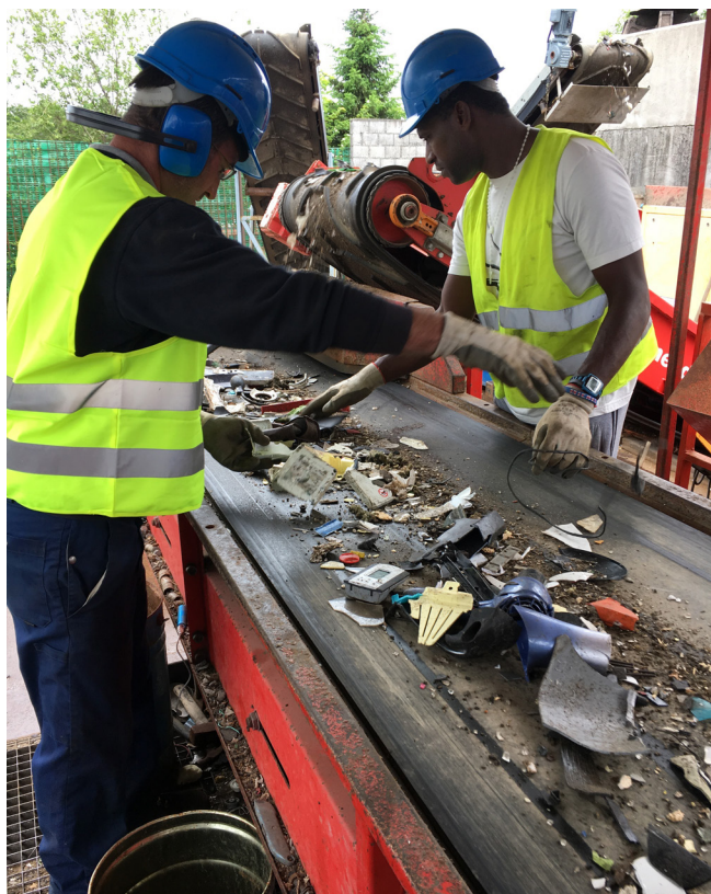
Tri à la main des matières valorisables et polluants à partir du convoyeur après broyage des appareils électroménagers chez Metabader SA.
