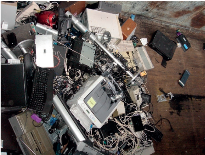
Abbildung 1: Elektroaltgeräte die von grosser Höhe aus Sammelboxen in einen Transportcontainer umgeschüttet wurden. Es ist deutlich zu sehen, dass Elektroaltgeräte aufplatzen und dabei können LIB sogar herausgeschleudert und beschädigt werden.
