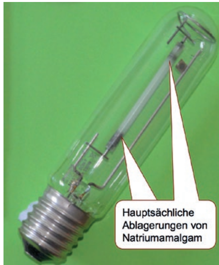
Abbildung 3: Natriumamalgamablagerungen in der erkalteten Brennzelle einer HPS-Lampe.
