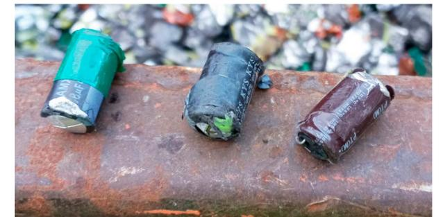
Foto 4–5: Beschädigte Kondensatoren nach mechanischer Behandlung.
