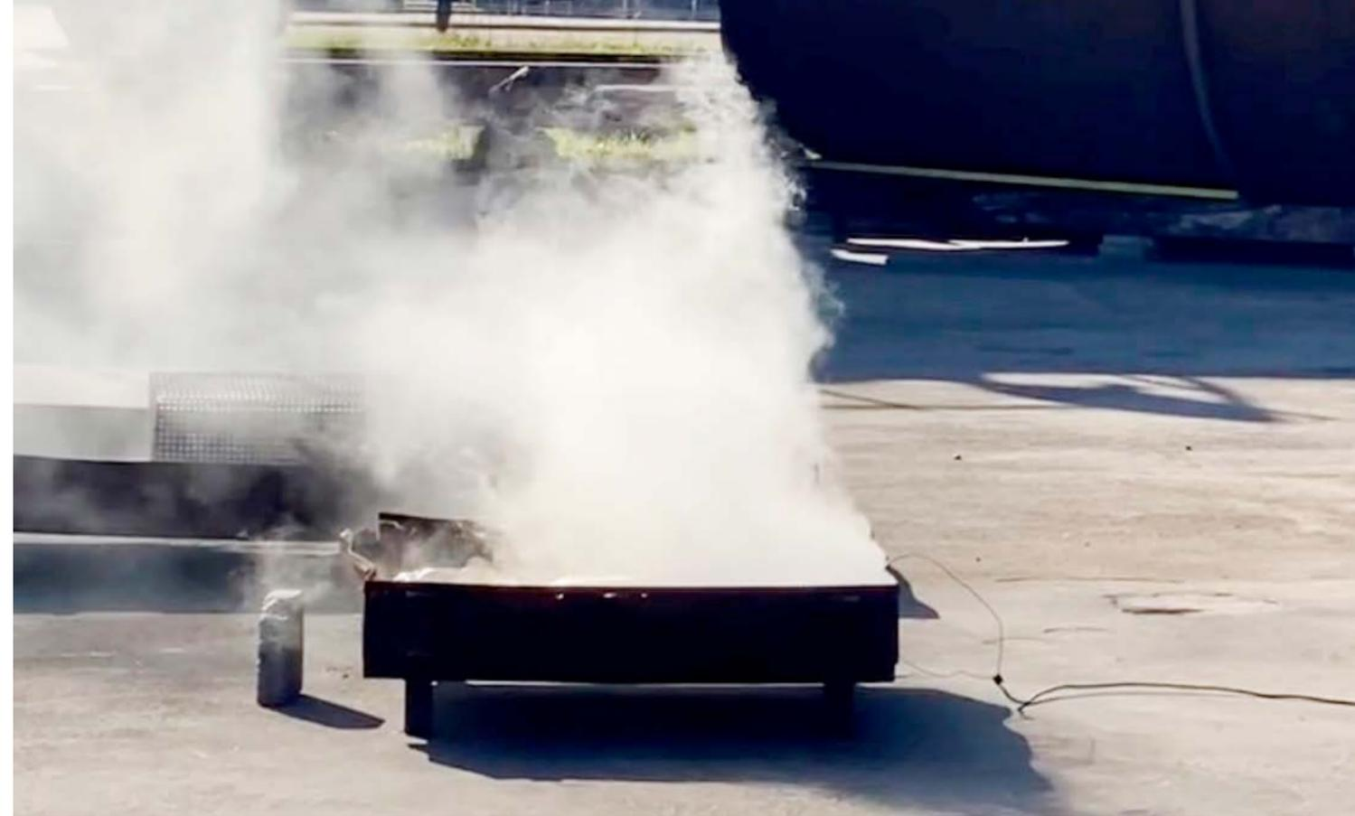
Foto 2: Phase 1 – Der «Thermal Runaway» (Kettenreaktion im Akku) aufgrund des Kurzschlusses einzelner Zellen.
