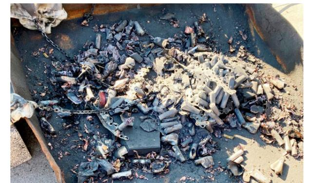
Foto 4: Phase 3 – Die Rückstände nach Abschluss des Brandversuches.
