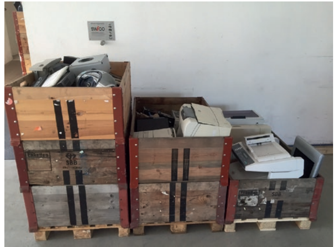
Fig. 2: Palettes en bois CFF avec cadre dans un centre de collecte Swico. Afin d'éviter tout endommagement, les DEEE ne doivent pas dépasser des cadres (empilés par trois au maximum).
