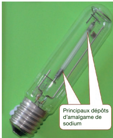
Fig. 3: Les dépôts d'amalgame de sodium dans le brûleur refroidi d'une lampe SHP
